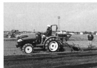
写真2. 乗用トラクター装着型 局所施肥同時マルチャー
